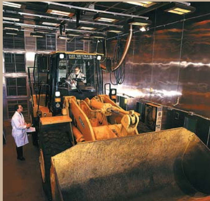
Las condiciones extremas en temperatura, humedad, velocidad del viento y carga solar se duplican en la cámara ambiental grande para validar el rendimiento de los sistemas de climatización de cabinas de Bergstrom.
